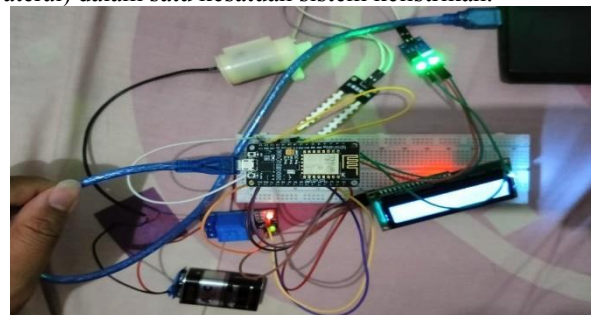
Gambar 7 Prototipe perangkat keras sistem penyiraman otomatis
