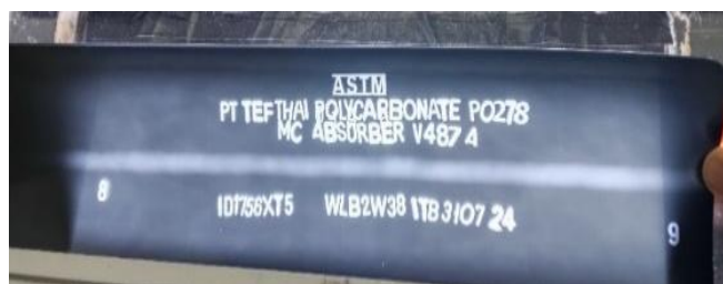
Gambar 4 Hasil radiography test pada area WL. B-2 repaired
